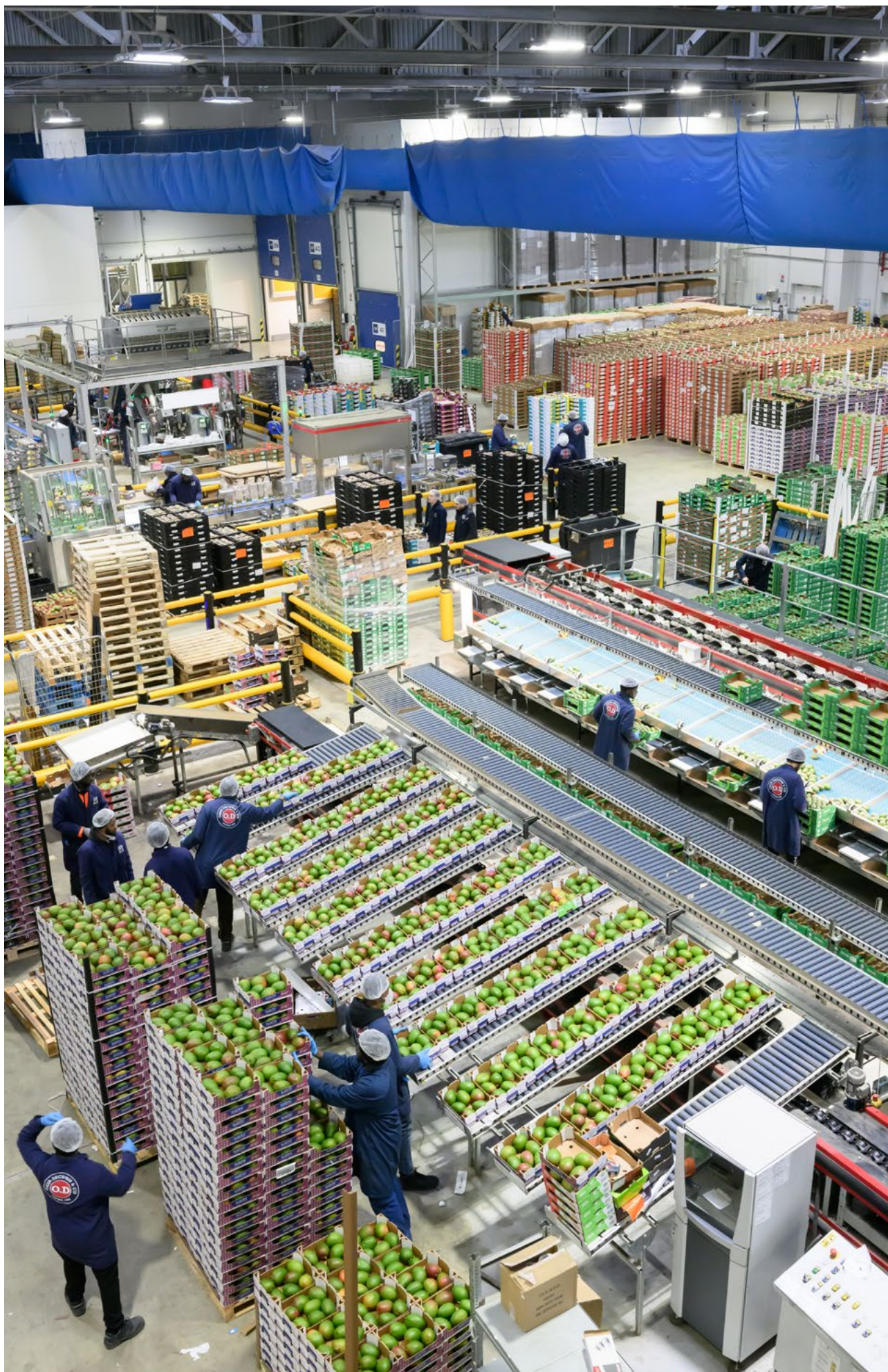
Sélection par maturité d'avocats sur machine Aweta - SIIM, MIN Rungis, France
